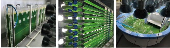
フラットパネル型 チューブ型 レースウェイ型
