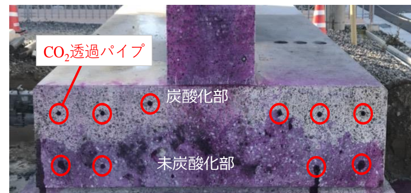
< 切断面の炭酸化範囲 >
