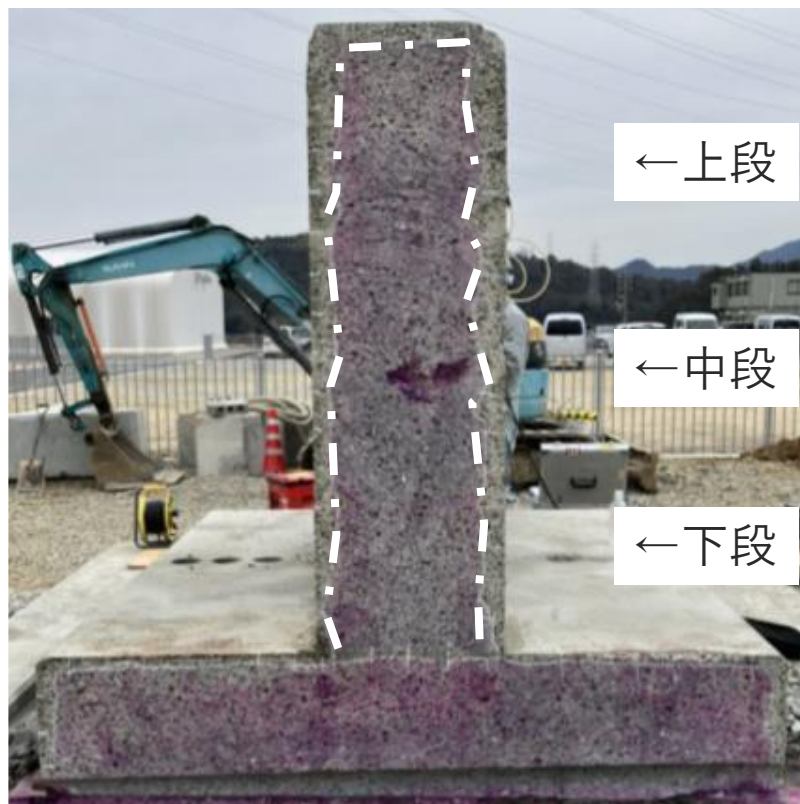
<切断面の炭酸化範囲>
