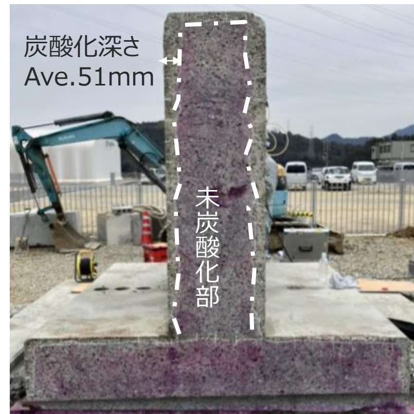
<切断面の炭酸化範囲>
