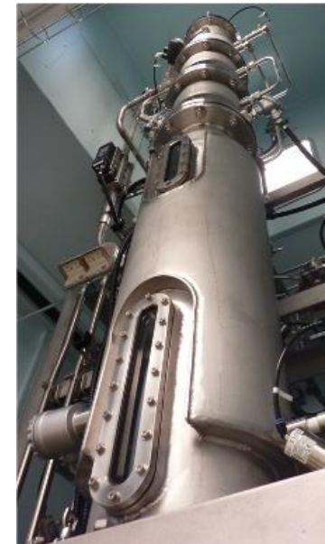
H 2 を高効率で供給する気泡塔型酢酸発酵槽
